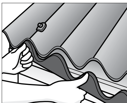
Bring fugleklodser eller fuglegitter på plads, og rens tilstoppede ventilationsåbninger/hætter.
